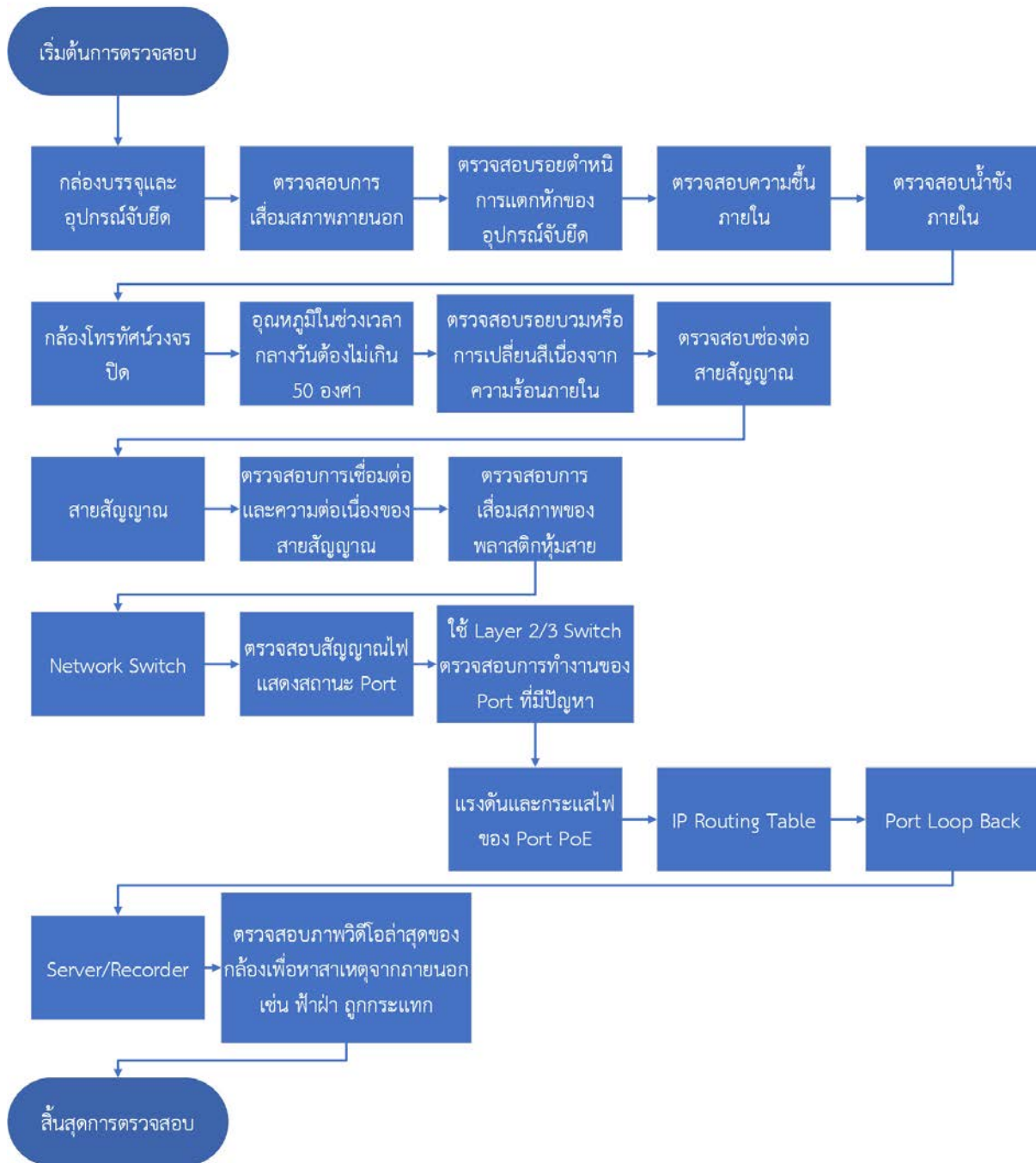
รูป ๑๖ รูปภาพแสดงขั้นตอนการตรวจสอบอุปกรณ์
